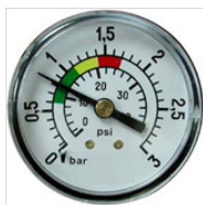
0,8 kg/cm 2 : Presión inicial de un filtro al iniciar un ciclo de filtración
