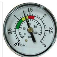
1,3 kg/cm 2 : Der Druck beträgt 0,5 kg/cm 2 mehr als der Anfangsdruck. Das bedeutet, dass eine REINIGUNG notwendig ist
