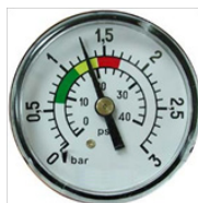
1,3 kg/cm 2 : La presión es 0,5 kgs/cm 2 superior a la inicial, esto indica que es necesario proceder al LAVADO
