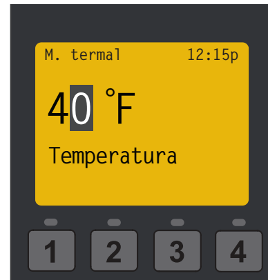
Configuración de la temperatura de la bomba en modo Thermal
